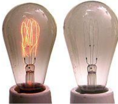
Lámparas incandescentes de carbón. Se aprecia el oscurecimiento de la ampolla de vidrio
